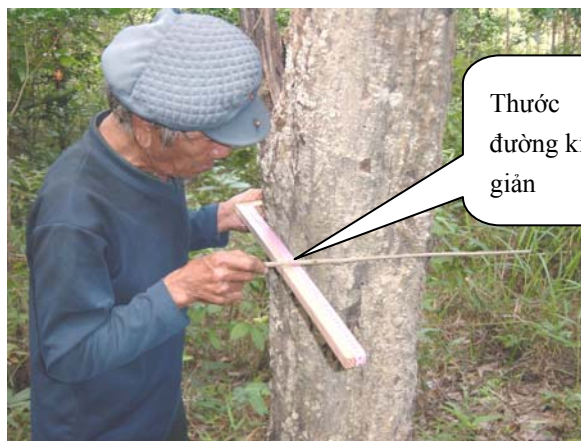
Người dân đo đường kính cây bằng thước kẹp tự tạo
